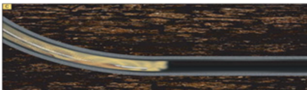
Figure 4. A previously planned bit length is reached and the jet cleaning tool is lifted to the top of the short cladding pipe (liner) to start the sweep process / Figura 4. Se alcanza una longitud de bocado previamente planificada y se sube la herramienta de limpieza por chorro hacia el extremo superior de la tubería de revestimiento corta (liner), para dar comienzo al proceso de barrido
