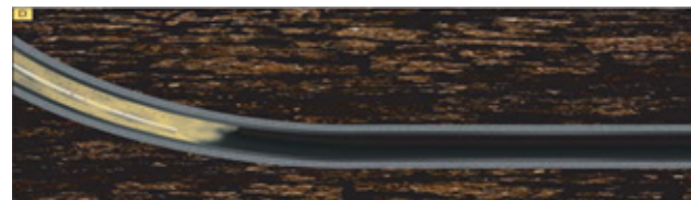
Figure 5. The filler is being swept through a portion of the critical angular section (40–65°) of the well / Figura 5. El relleno está siendo barrido a través de una porción de la sección angular crítica (40 a 65 grados) del pozo
