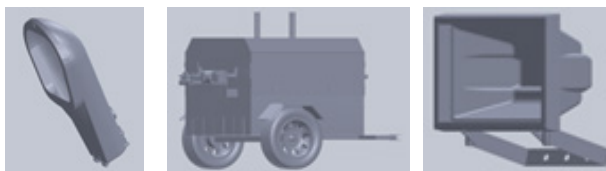
Figure 9. Designs of parts for illumination in SolidWorks for creation of spaces (lamp post, power plant, reflector) / Figura 9. Diseños en Solid Works de piezas para iluminación en el arme de locación (Luz posta, planta estadio, reflector)
