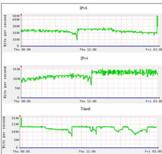
Figure 12. Real time measurement of throughput with Zennos / Medición en tiempo real del throughput con Zennos
